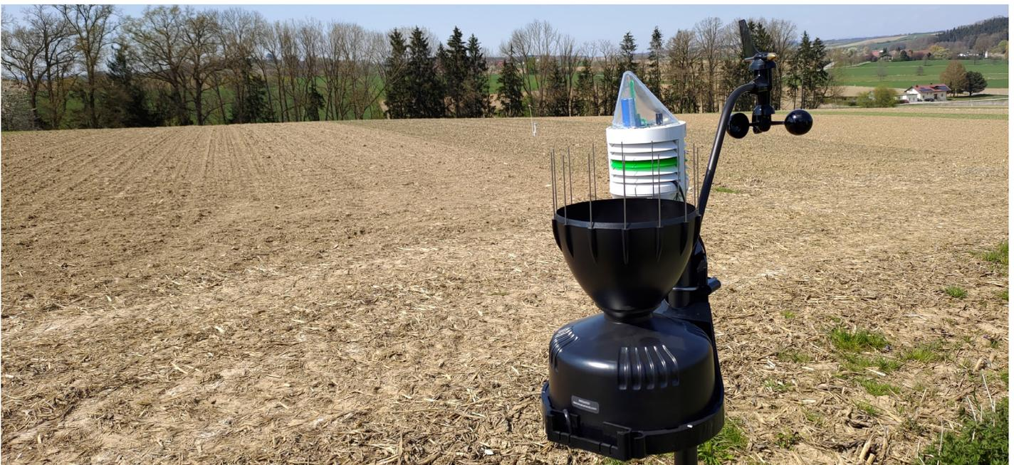
Die von Agvolution entwickelten und produzierten Mikroklimasensoren erfassen Temperatur, Niederschlag und Bodenfeuchte und übertragen diese regelmäßig per Narrowband-IoT oder 5G-Mobilfunk an die zentrale Datenplattform des Unternehmens.
