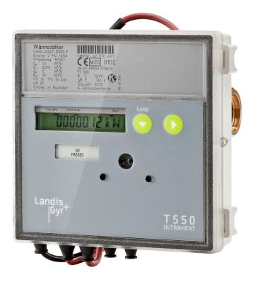
Die IoT-SIM-Karten für die Nutzung von Narrowband-IoT im Vodafone-Netz sind bereits in den Wärmemengenzählern integriert. Die Zähler lassen sich auch im Retrofit nachrüsten und erfassen die Verbräuche über die Menge des zugeführten Heißwassers. Dieses Prinzip wird unter anderem auch bei Fernwärme- und Nahwärme-Versorgung eingesetzt.
