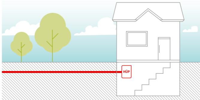
Die Glasfaser wird durch ein kleines gebohrtes Loch von 16 mm Durchmesser ins Gebäude geleitet, welches anschließend gas- und wasserdicht versiegelt wird. An dieser Stelle wird dann der Hausübergabepunkt (HÜP) gesetzt. Nach Absprache geschieht dies meist im Keller oder Hauswirtschaftsraum.
