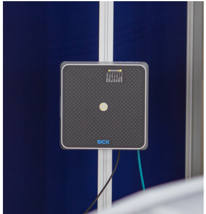
RFID-Scanner erfassen angeliefertes Material.
