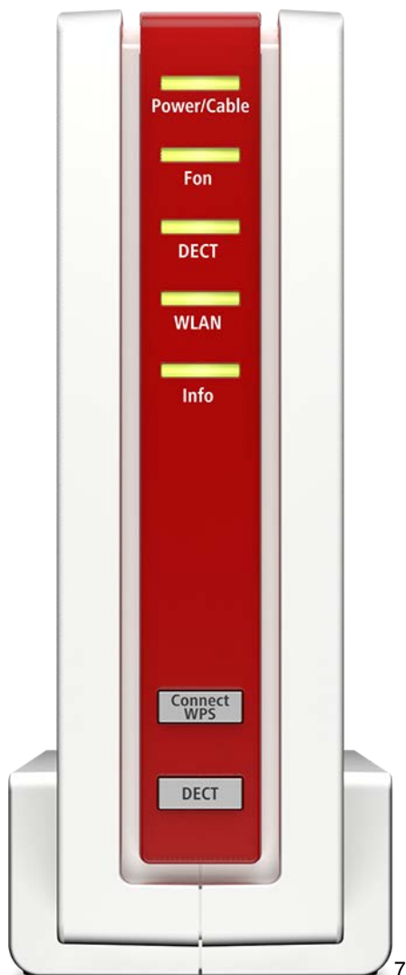
Abb. 3: LED an der FRITZ!Box 6591 Cable
