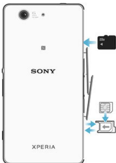
! Legen Sie die Nano-SIM-Karte in den Nano-SIM-Kartenhalter ein, bevor Sie die Karte in das Gerät einlegen. Verwechseln Sie den Nano-SIM-Karteneinschub außerdem nicht mit dem Speicherkarteneinschub.
