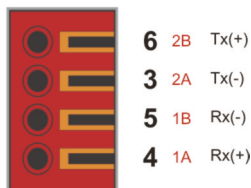
Kontakt-Belegung des ISDN-S 0 -Klemmanschlusses
