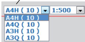
Durch Betätigen der Schaltfläche
