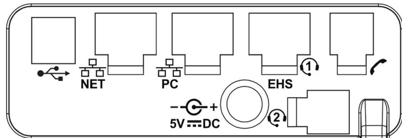
2. Schließen Sie das Ethernet-Kabel an die Buchse **NET** an. Das andere Ende des Kabels verbinden Sie mit Ihrem Netzwerk, um den Datenaustausch zu ermöglichen. Für die Dauer der Nutzung des Telefons muss eine ständige Verbindung zu OfficeNet bestehen.
