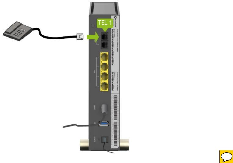
Schließen Sie das kabelgebundene Telefon, die DECT-Basisstation oder das Faxgerät an einen der **TEL**-Anschlüsse am CGA6444VF an.
