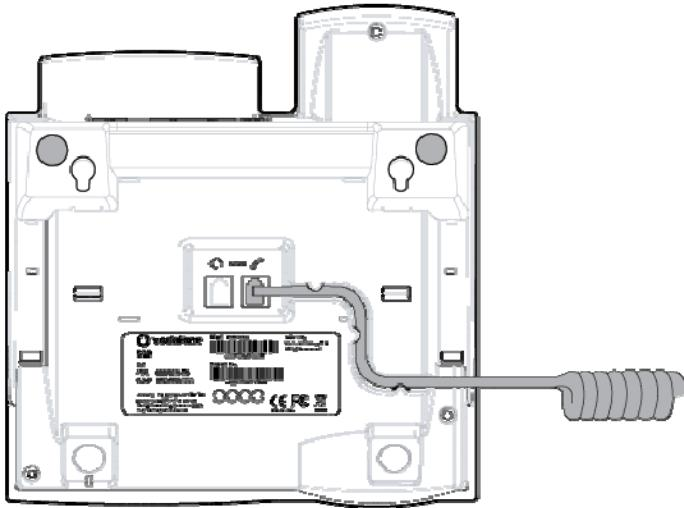
2. Schließen Sie das Ethernet-Kabel an die Buchse **NET** an. Das andere Ende des Kabels verbinden Sie mit Ihrem Netzwerk, um den Datenaustausch zu ermöglichen. Für die Dauer der Nutzung des Telefons muss eine ständige Verbindung zu OfficeNet bestehen.
