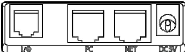
3. Wenn Sie eine externe Stromversorgung benötigen, weil eine Stromversorgung über Ihr Netzwerk (Power over Ethernet) nicht verfügbar ist, stecken Sie den Stecker des Netzteils in die Buchse **DC5V** und schließen Sie das Netzteil an die Stromversorgung an.
