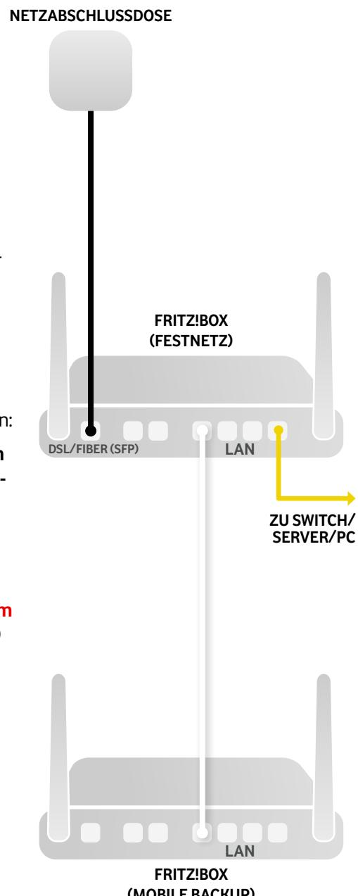
**i** Hinweis: Die FRITZ!Box (Mobile Backup) für die Outdoor-Installation kann sich **bis zu 100 Meter entfernt** vom PoE-Netzteil befinden. **Warnung: Das Netzteil ist ausschließlich im Innenbereich von Gebäuden zu verwenden!**
