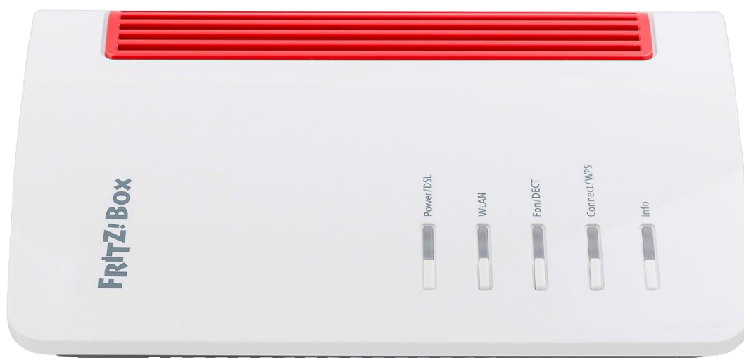
Abb. 15: LED an der FRITZ!Box 7530 AX/7690
