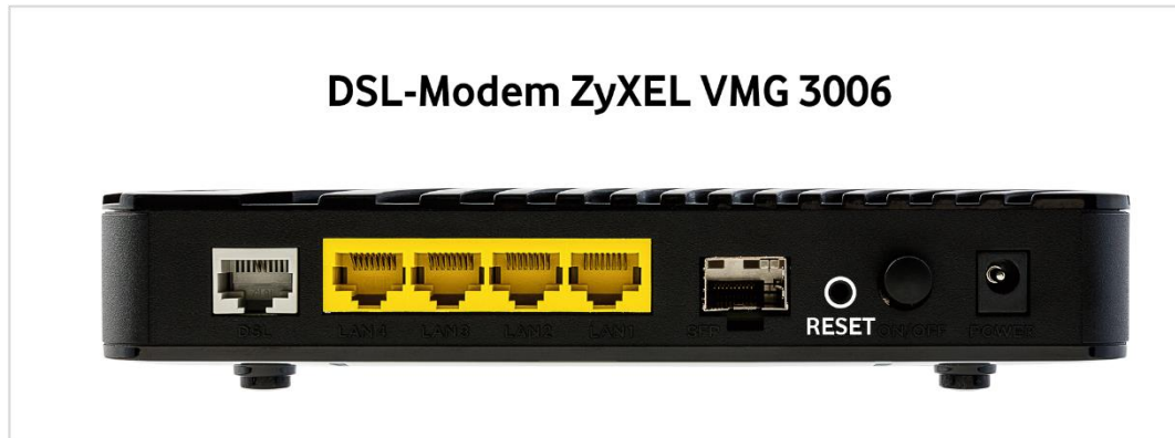
Abb. 95: DSL-Modem ZyXEL VMG 3006, versenkte Taste RESET
