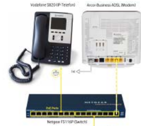
Abb.: Installation mit Modem Arcor Business ADSL
