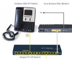
Abb.: Installation mit Modem Arcor Business SDSL
