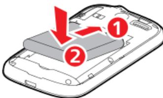
1. Setzen Sie zuerst die mit **a** markierte Seite des Akkus (mit den Kontakten) in den unteren Bereich des Batteriesteckplatzes ein.
