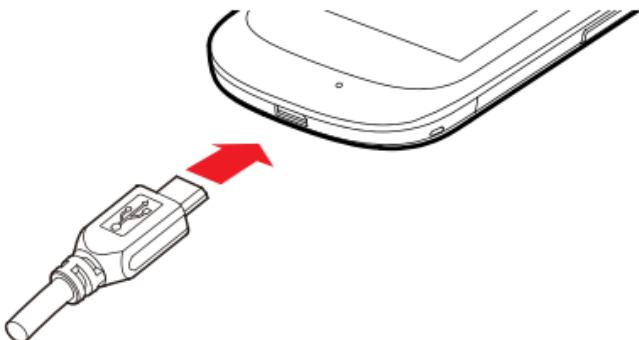
1. Verbinden Sie das im Lieferumfang enthaltene USB-Kabel mit dem Ladegerät.
