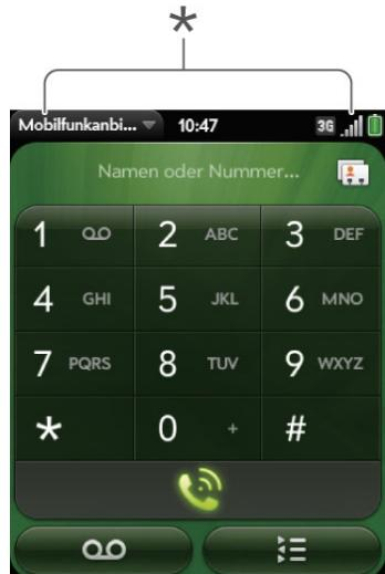
\* Diese zeigen an, dass das Telefon eingeschaltet ist.
