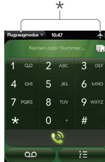
\* Diese zeigen an, dass das Telefon ausgeschaltet ist (Flugzeugmodus).
